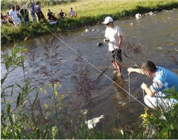
Фото 17 – Измерение расхода воды в реке Мармарик
